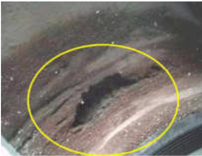
Bild 5: Gehäuseerosion eines Drehkegelventils durch Kavitation Fig. 5: Erosion in a rotary plug valve body induced by cavitation
