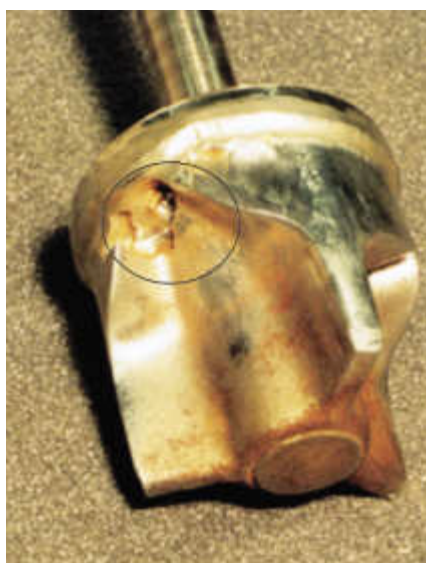
Bild 2c: Im Schließbereich verschlossener Stellventilkegel (siehe auch Bild 2b).
